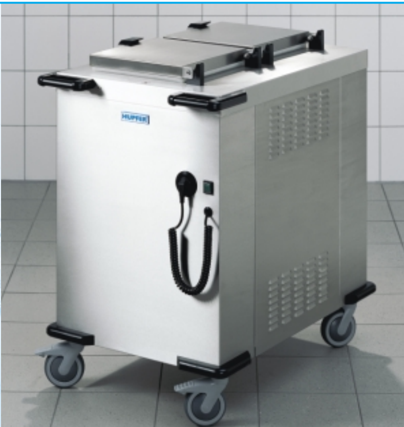
Powerstapler® TEUH-2/26 P. Deze speciale stapelaar heeft een vermogen van 3 kW en wordt gebruikt voor het voorverwarmen van roestvrijstalen wasgevulde pellets. Het uitgekiende luchtgeleidingssysteem in combinatie met twee elementen met achteregebouwde ventilator en speciale dubbelwandige deksels brengen 2 x 44 pellets in maar 3,5 uur op een temperatuur van meer dan 120 graden Celsius.
