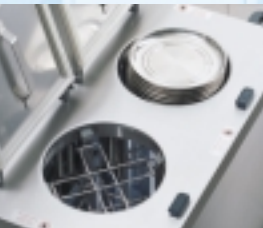
Powerstapler® TEUH-2/26 P. Deze speciale stapelaar heeft een vermogen van 3 kW en wordt gebruikt voor het voorverwarmen van roestvrijstalen wasgevulde pellets. Het uitgekiende luchtgeleidingssysteem in combinatie met twee elementen met achteregebouwde ventilator en speciale dubbelwandige deksels brengen 2 x 44 pellets in maar 3,5 uur op een temperatuur van meer dan 120 graden Celsius.
