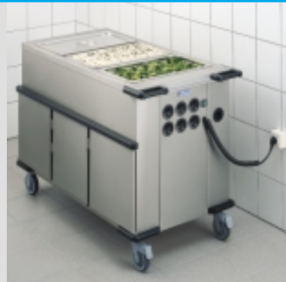
SPTW-3/EBF Uitgevoerd met 3 bakken voor maximaal GN 1/1-200 of onderverdelingen daarvan. Voorzien van 3 verwarmde compartimenten in de onderbouw.
